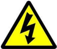
Символът светкавица със стрелка, вграден в равностранен триъгълник, е предназначен да предупреди потребителя за наличието на неизолирано опасно напрежение във вътрешната част на продукта, което може да е достатъчно силно за да представлява риск от злополука с електрически ток.
