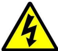
A háromszögbe rajzolt, nyílban végződő villámszimbólum arra figyelmezteti a felhasználót, hogy a rendszer burkolatán belül veszélyes nagyságú, szigetelés nélküli feszültség található, amely elég erős ahhoz, hogy áramütést okozzon.
